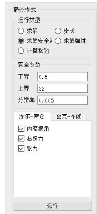
单击“运行”按钮后，程序开始计算安全系数。你将看到下面的屏幕，在主窗口顶部显示 1.143 的临界安全系数。同样的模型在 Slide 和 RS2 中计算（这两个商业软件由 Rocscience 开发），极限平衡安全系数分别为 1.14 和 1.15。
